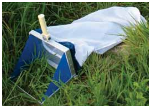
FIGURE 2 : ECHANTILLONNEUR SURBER UTILISE LORS DES PRELEVEMENTS ET DIMENSIONS DE LA NORME
