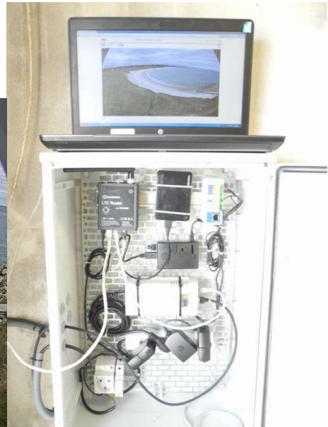
Figure 20. Base d'enregistrement (photo : Emmanuel AUGEREAU, UBO)
