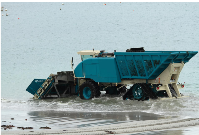
Figure 18 : Machine d'AGRIVAL en action de ramassage d'ulves - cliché Laurent PERCHIRIN
